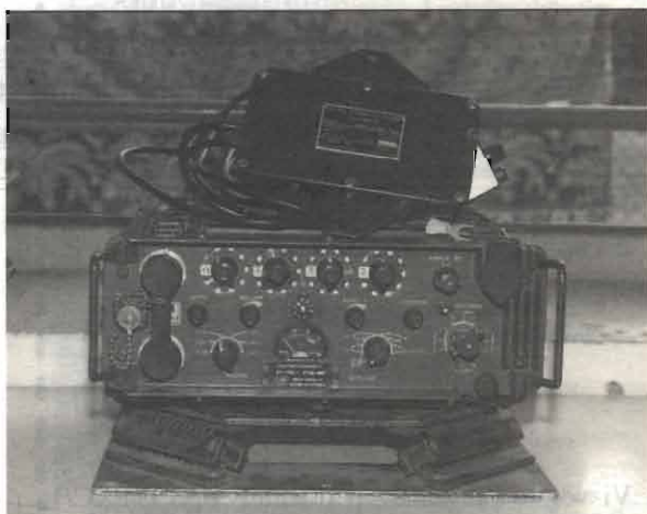
Foto 3 - PRC 1. Montato su mounting veicolare e filtro stabilizzatore di tensione tipo FL-1/RH-4.
